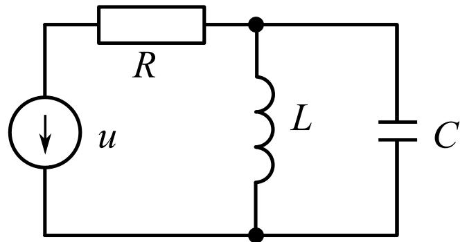
**Příklad 5\_3:** V ustáleném obvodu určete průběh proudu  $i_R$  a napětí  $u_R$ .
