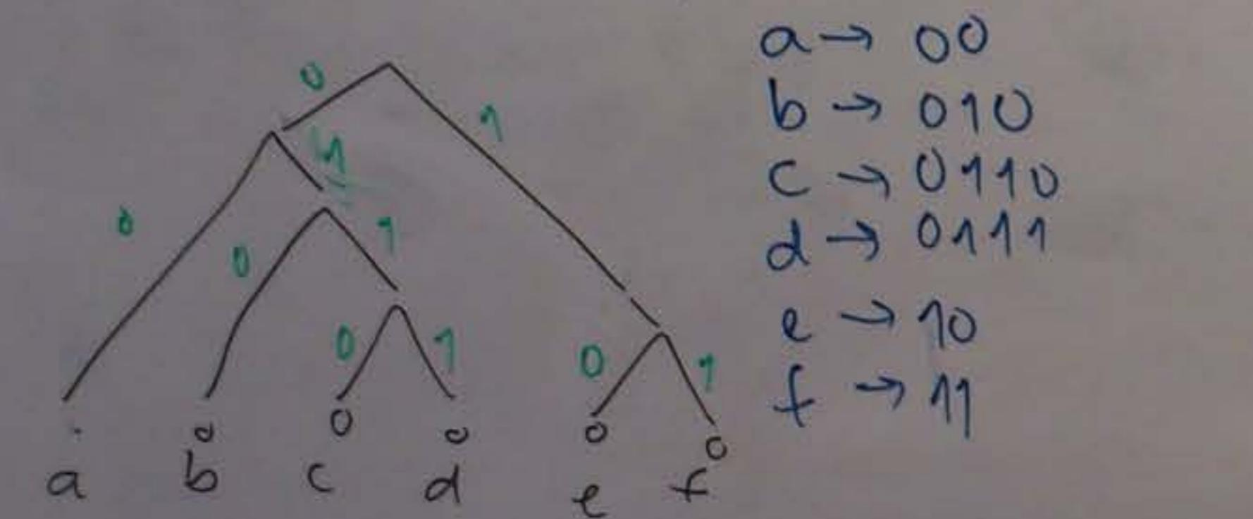
$$\begin{aligned} a &\rightarrow 00 \\ b &\rightarrow 010 \\ c &\rightarrow 0110 \\ d &\rightarrow 0111 \\ e &\rightarrow 10 \\ f &\rightarrow 11 \end{aligned}$$
