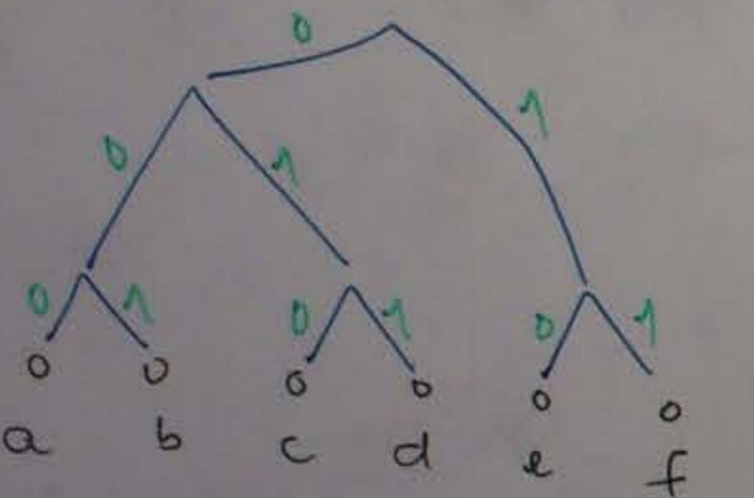
$$\begin{aligned} a &\rightarrow 000 \\ b &\rightarrow 001 \\ c &\rightarrow 010 \\ d &\rightarrow 011 \\ e &\rightarrow 10 \\ f &\rightarrow 11 \end{aligned}$$
